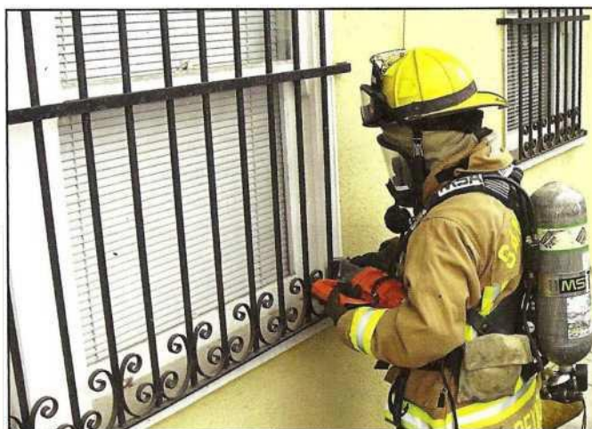
Fot13.115 Barele de la fereastră pot fi tăiate cu tăietori hidraulice.
