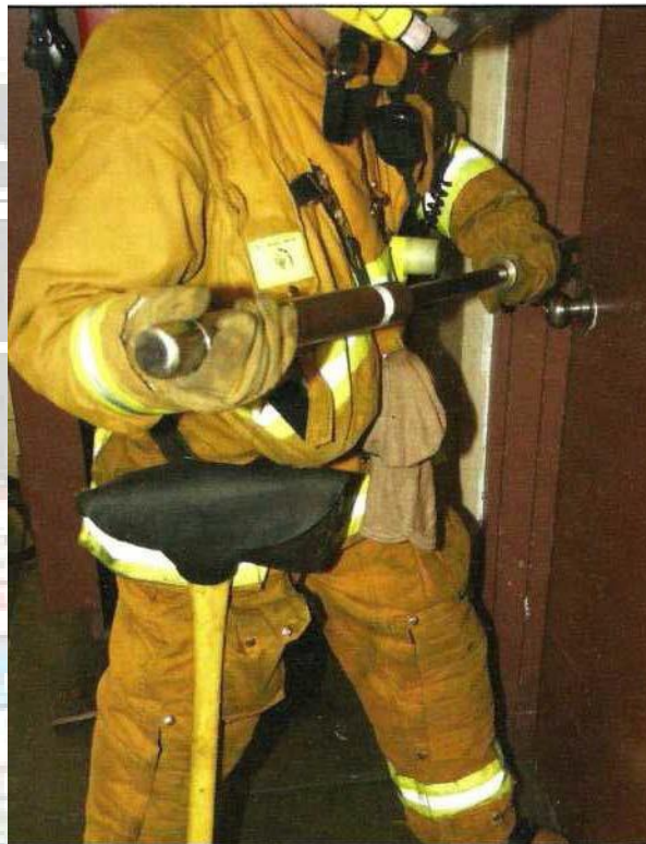
Fot13.74 Un pompier poate folosi o rambar pentru a forța deschiderea unei ușă.
