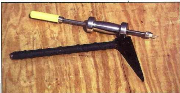
Fot13.97 Șurubelniță de lăcătuș și ciocan cu vârf de rață pentru a sparge încuietorile pot fi folosite pentru a sparge candelă
