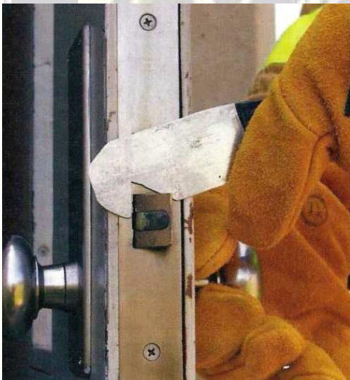
Fot13.94 un instrument pentru împingerea încuietorilor în uși batante exterioare. Panoul se inserează între ușa și cadrul și se folosește pentru a înfunda zăvorul
