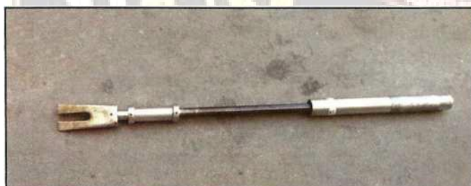
Fot13.19 La rambar necesită doar un operator y este un instrument eficient pentru a deschide uși cu încuietore.
