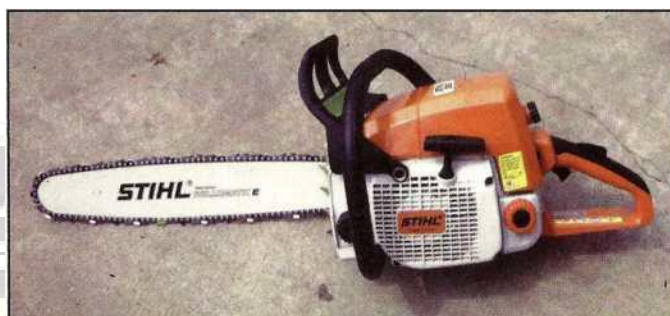
Fot13.16 Ferăstraiele cu lanț sunt utile pentru tăiați materiale de acoperiș atunci când se ventilează o structură.
