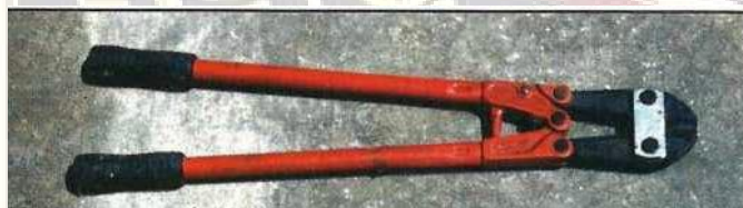
Fot13.5 Los scurtează piulițele (foarfeci) pot tăiați șuruburi, lanțuri, yanke cu uși de blocare y lacăte care nu sunt întărite.
