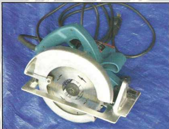
Fot13.13 Feroneria circulară necesită o sursă de energie electrică. Există o varietate mare de discuri pentru sierra în funcție de tipul de material ce trebuie să taie.
