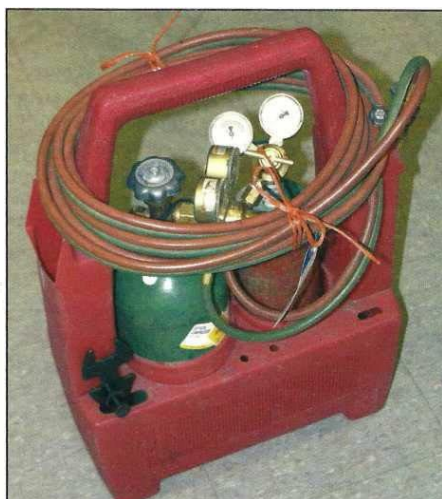
Fot13.8 Utilizarea torțelor de tăiere cu oxiacetilen portabile sunt diminuate în serviciul de pompieri. Fără embargo, unele echipamente portabile de oxiacetilenă ca cel care este prezentat pot fi găsite în serviciu în câțiva departamente.
