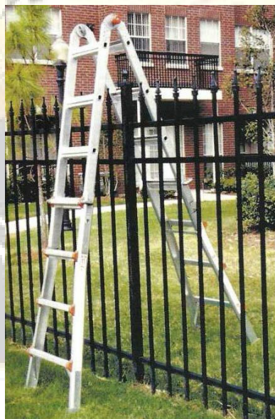
Fot13.102O scară poate fi folosită pentru pasar rapid o cercetare de metal fără a deteriora la caută o tăia
