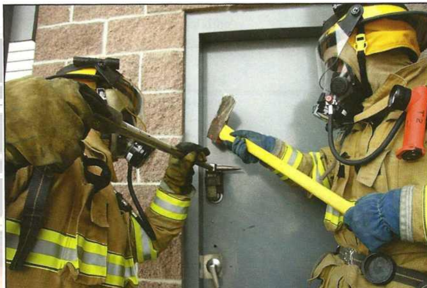
Fot13.91 Atada con la barra, herramienta K este transportat în jos spre încuietoare folosind o topor.
