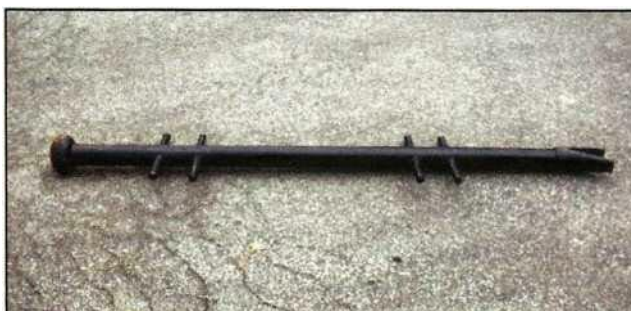
Foto 9.118 Un tipic berbec folosit pentru rup multe tipuri de pereți și uși.
