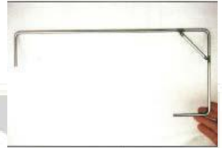
Fot13.93 Unealta J este folosită pentru a manipula bara într-un anumit tip de echipă anti panică
