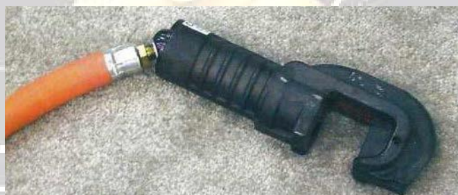
Fot13.6 Tăietorii de bară de armare manual și hidraulic pot tăia metale care tăietoarele de șuruburi nu pot
