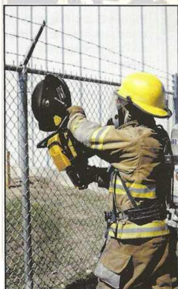
Fot13.101O ferăstrău giratoriu poate ser folosită para tăia cercetează rapid.
