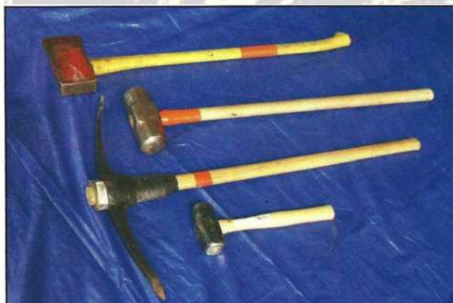
Fot13.27 O varietate de unelte pentru lovit, inclusiv ciocanul, toporul de cap plat, și pica
