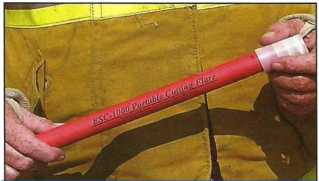
O torț ă de tăiere tipică care genera flăcări de temperaturi ridicate asupra un perioadă scurtă de timp
