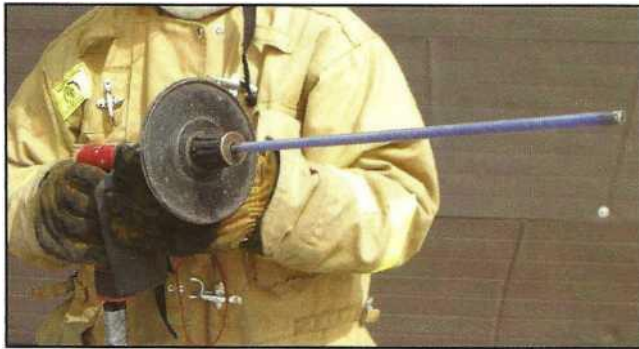
Fot13.10 O bară de tăiere tipică folosită pentru a tăia prin materiale de concrete, non-metallic, or compounds.
