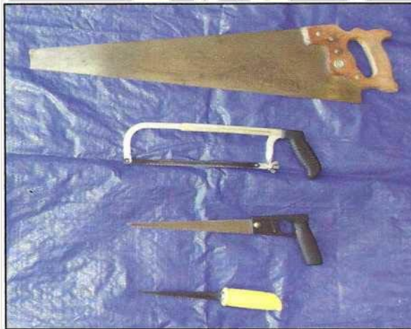
Fot13.12 Fierăstraie manuale tipice, utilizate pentru tăierea unei varietate de materiale
