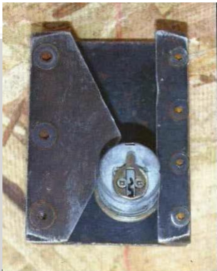
Fot13.90 Unelte K este conceput pentru a mușca în cilindrul încuietorii.
