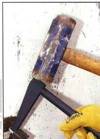
Fot13.98 El martillo de pico de pato pentru spargerea lacătelor se poartă în interiorul cătușei pentru a-l sparge
