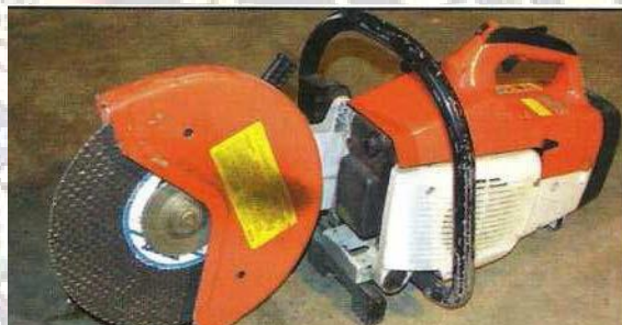
O ferăstrău tipic rotativ este mai mare decât feroneria circulară și nu necesită o sursă de alimentare separată.
