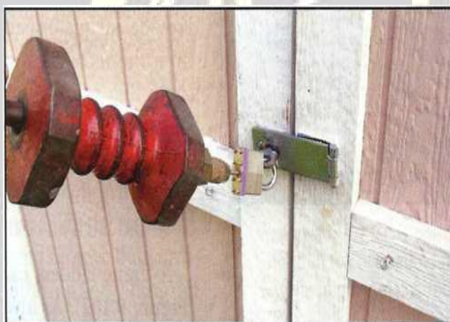
Fot13.99 El șurubelniță de cerrajer în interiorul unde se pune cheia carabinierului și folosit pentru a trage cilindru afară din lacăt. Aceasta unealta nu va functiona pe lacate de marcă un lacăt de înaltă securitate.
