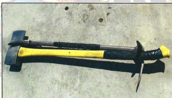
Fot13.32 Un set tipic de fier format printr-un ax cu cap plat și o bară Halligan
